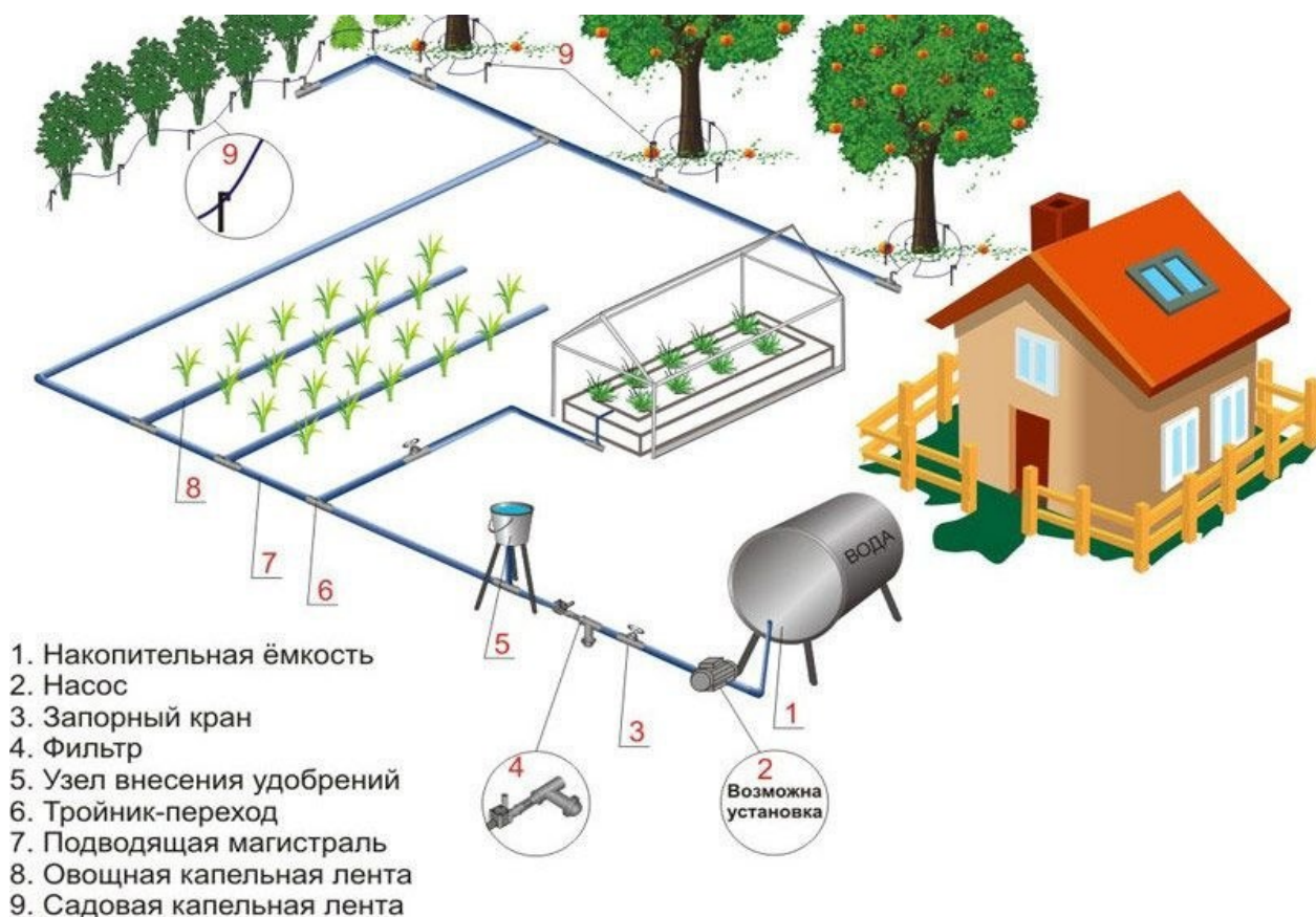
Рисунок 2 - Общая схема системы капельного полива
