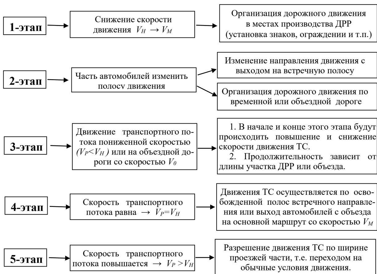
Рис. 2. Этапы организации движения транспортного потока в местах производства дорожно-ремонтных работ
